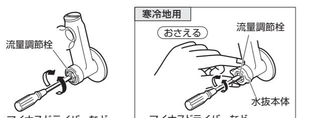
吐水口・流量調節栓(流量調節栓付の場合)を長期間回さずに使用すると水あかなどが付着し、無理に回そうとすると、水漏れ・異音の発生の原因になります。
