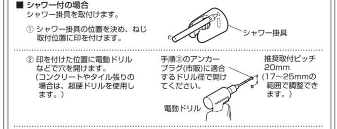
② 印を付けた位置に電動ドリルなどで穴を開けます。（コンクリートやタイル張りの場合は、超硬ドリルを使用します。）
