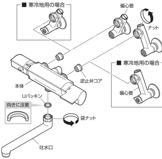
(2) モンキーレンチなどでナットをしっかりと締付け、水栓を偏心管に固定します。
