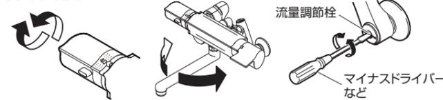
流量調節栓を回す際は設定位置を確認し、回した後に元の位置に戻してください。寒冷地用は水抜本体をもって回してください。参照：「流量調節」
