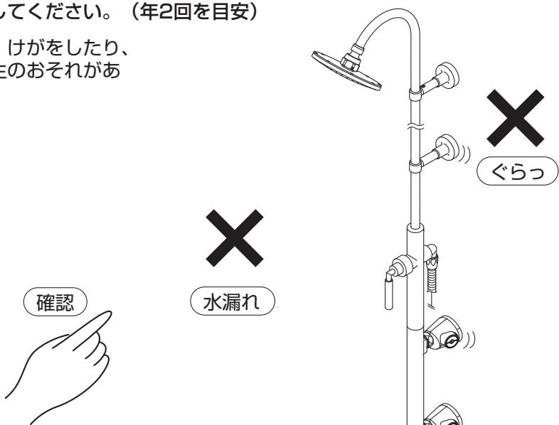
漏水を確認した場合は、流量調節栓または配管中の元栓を閉めてください。
