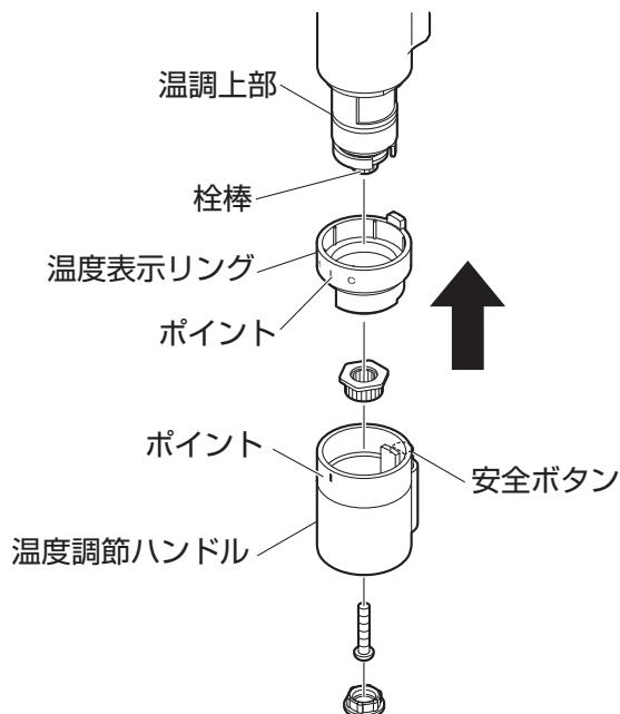
(注) ● 温度調節ハンドルを取付ける時、栓棒を回さないようにしてください。
