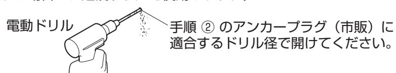
② 電動ドリルなどで開けた穴にアンカープラグを差し込みます。
