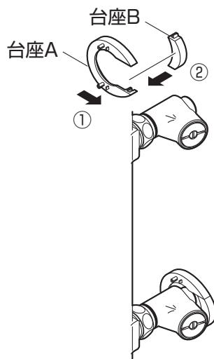
(2) 左右の断熱カバーを台座に押し当てながら突起に合わせ、カチッと音がするまで挟み込みます。挟み込んだ後、断熱カバーを壁面に押し付けます。
