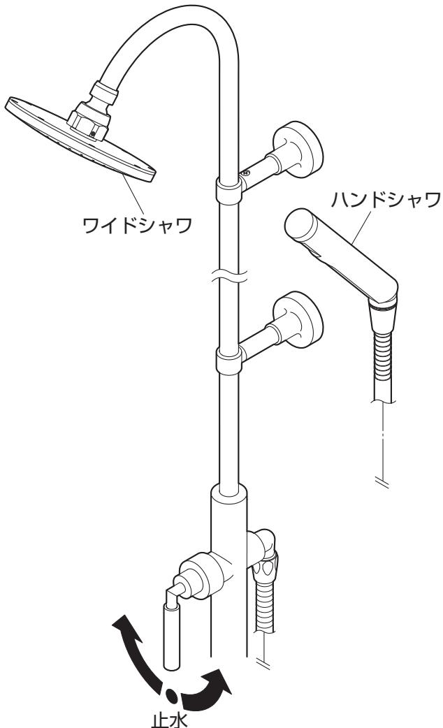
快適なシャワ（吐水量が10L/分）になるように流量調節栓などで流量調節してください。
