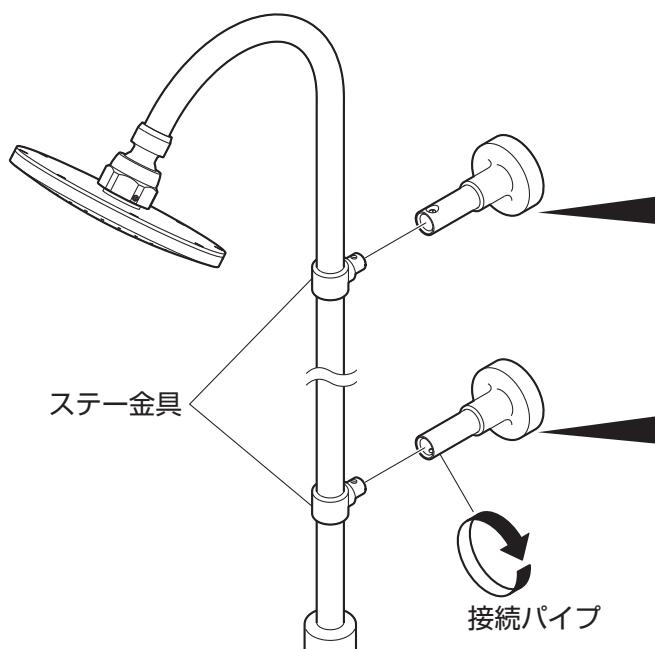
バー中心と取付金具がずれている場合は、止めねじをゆるめて、位置調整してください。
