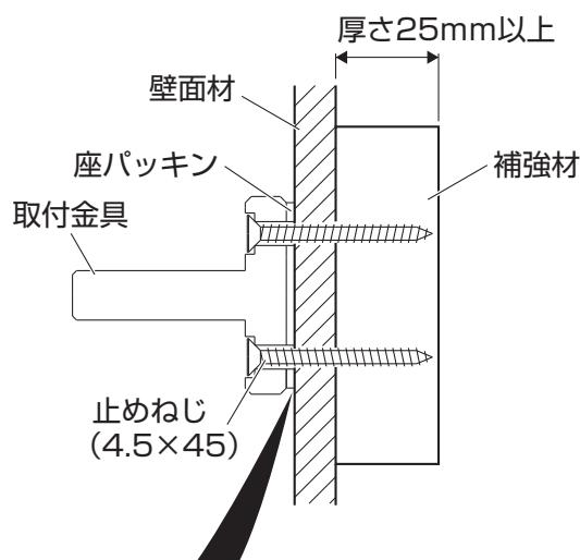
取付金具穴の中心に止めねじを取り付けてください。
