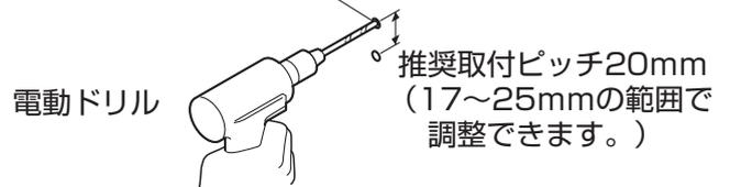
③ 電動ドリルなどで開けた穴にアンカープラグを差し込みます。
