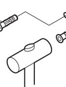
(3) シャワ掛具を止めねじでしっかりと固定します。最後に穴をキャップでふさぎます。
