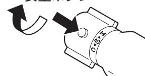
※安全ボタンを押して温調ハンドルをまわしても高温の湯が出ないときは、給湯機（給湯リモコンなど）の給湯温度を50~60°Cに設定した後、水栓側の温度調節ハンドルをH側へまわしてください。
