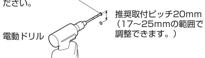
③ 電動ドリルなどで開けた穴にアンカープラグを差し込みます。
