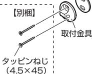
取付金具穴の中心にタッピンねじを取付けてください。(穴は本体を取付ける際、位置調整できるように左右2mmの幅を設けています。)
