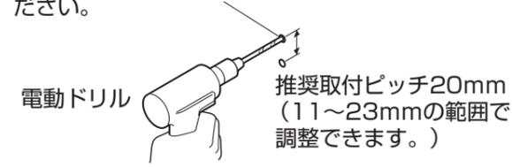
(3) シャワー掛具と壁の間にパッキンが入っている事を確認し、シャワー掛具を止めねじでしっかりと固定します。最後に穴をキャップでふさぎます。
