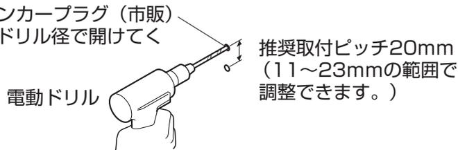
③ 電動ドリルなどで開けた穴にアンカープラグを差し込みます。
