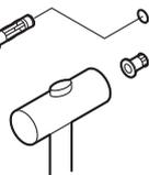
(3) シャワ掛具と壁の間にパッキンが入っている事を確認し、シャワ掛具を止めねじでしっかりと固定します。最後に穴をキャップでふさぎます。
