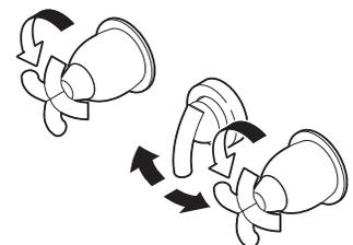
湯を使用する時は水側ハンドルを開いてから徐々に湯側ハンドルを開き、温度および吐水量を調節してください。
