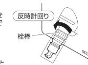
(2) 養生キャップをはずし、化粧カバーの目印と レバーハンドルの目印を合わせ、レバーハン ドルを取付けてください。
