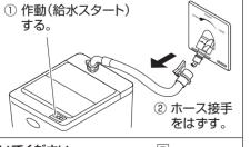
ホースを接続するまでレバーハンドルを開けないでください。 本製品の自動ストップ機能は緊急用です。 安全装置が動かなくなって給水ホースが取り付けることがで きなくなった場合は、安全装置を復帰してください。 参照:「故障? その前に」処置C
