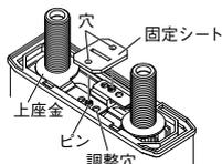
上座金の調整穴を座面裏側のピンにはめ込み、固定シートの穴をピン部に押し込んで固定してください。
