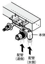
壁面を仕上げ、吐水口とレバーを取付けます。
