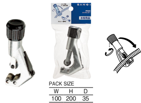
PR395 ¥3,300 5-50 パイプカッター ・単山ベンリーカンやパイプ (直径4〜28mm、 厚さ0.3mm以内)の切断可。
